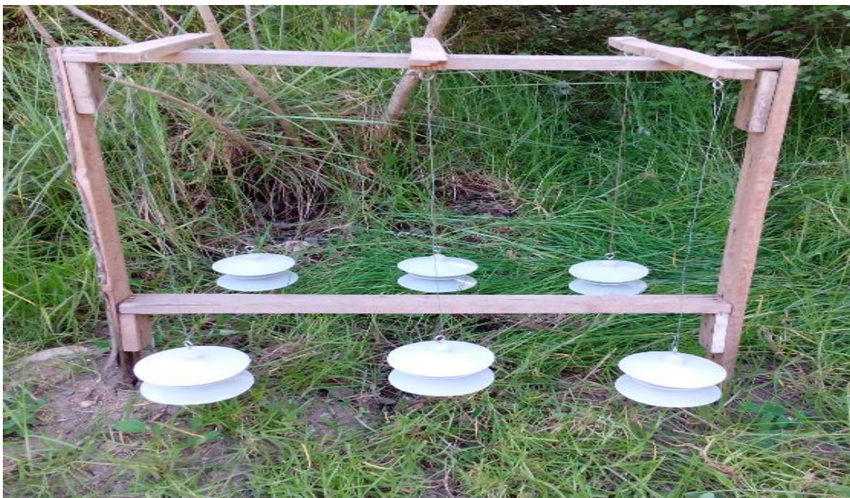
Fig. 4. 1 : Support en bois utilisé pour suspendre les isolateurs à l'air libre
