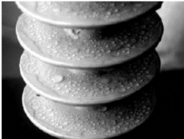
Fig. 1. 13 : Parties de dessous d'un isolateur en silicone après six jours de vieillissement dans la chambre de pluie [7]
