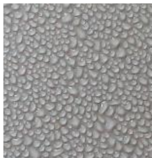
Fig. 4. 18 : Gouttes d'eau sur 1 cm 2 au secteur nord d'une surface prélevée après une heure d'exposition sous la condensation naturelle
