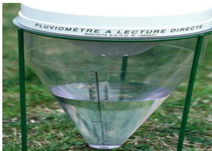
Fig. 3. 6 : Pluviomètre en forme d'entonnoir [41]
