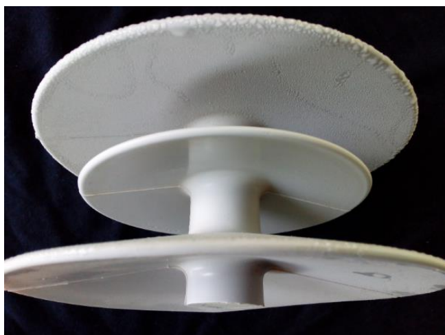
a) Vue partielle d’un isolateur à trois ailettes (tronc et ailette du milieu)
