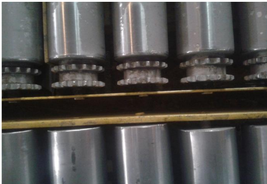
Figure .4 : Rouleaux en Acier comportant des pignons
