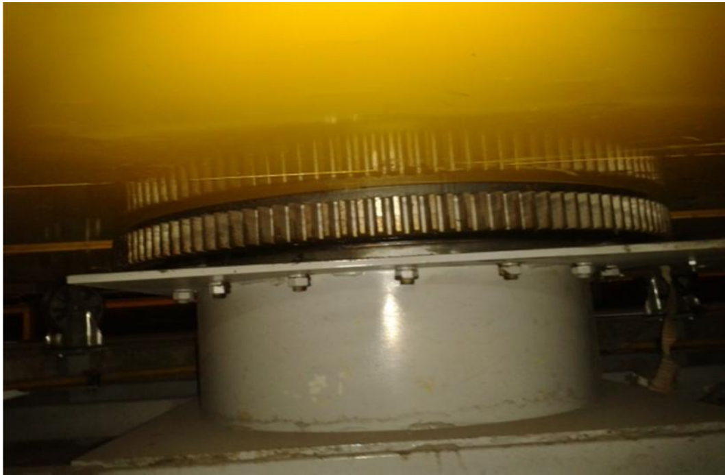
Figure .3 Vue de l'axe de support de la table comportant des dentures.
