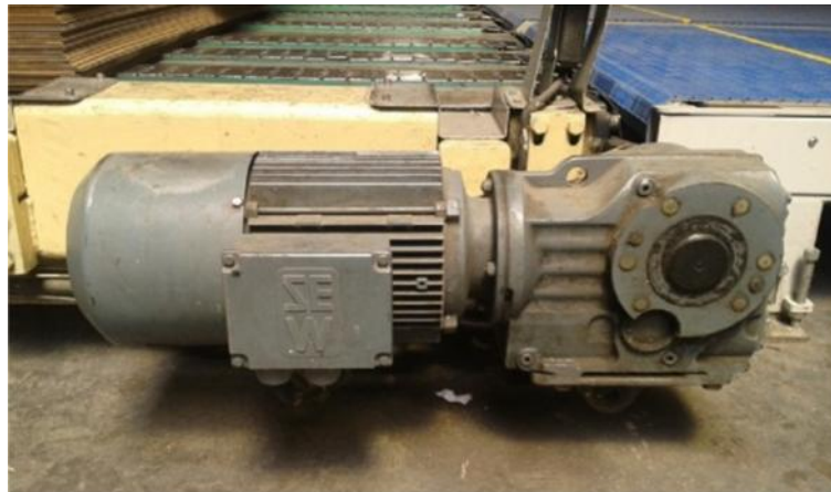
Figure .2 : Moteur asynchrone avec réducteur entrainant un convoyeur à bande
