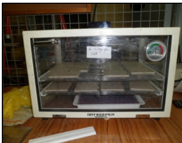
Fig. III.3 Echantillons de presspahn au cours de conditionnement dans le dessiccateur.
