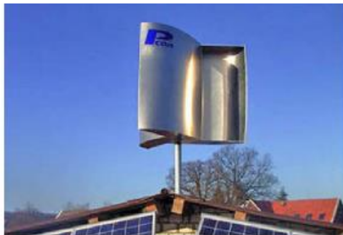
Figure II-9: Eolienne Savonius sur une toiture (25)
