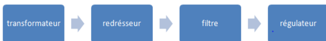
Figure III.18 : Schéma-bloc de la carte d'alimentation
