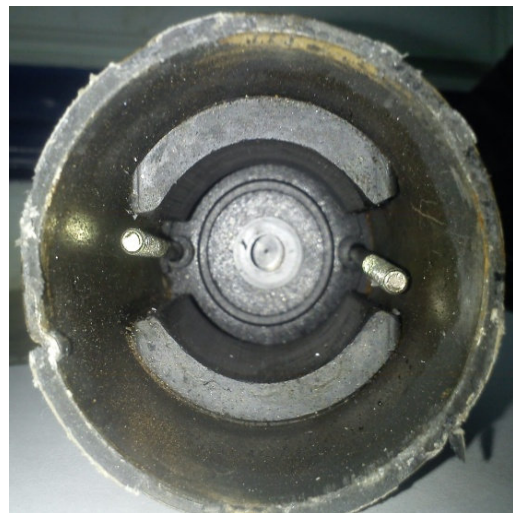
Figure II.16 : Le stator (inducteur)
