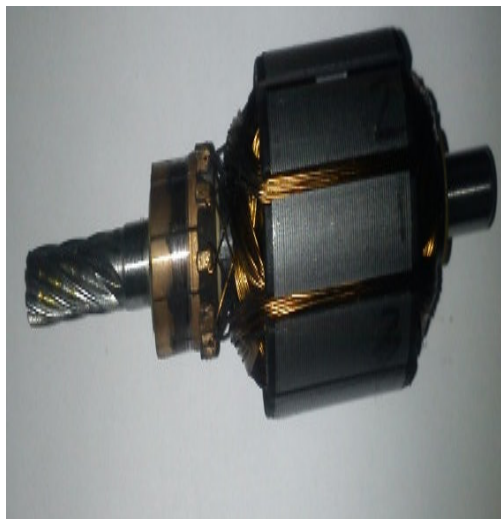
Figure II.15 : Le rotor (induit)
