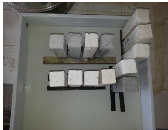
Figure24 : dispositif de la détermination de l'absorption d'eau par capillarité
