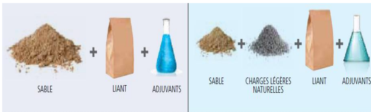
Figure06 : composition des enduits monocouches (lourds et légers).
