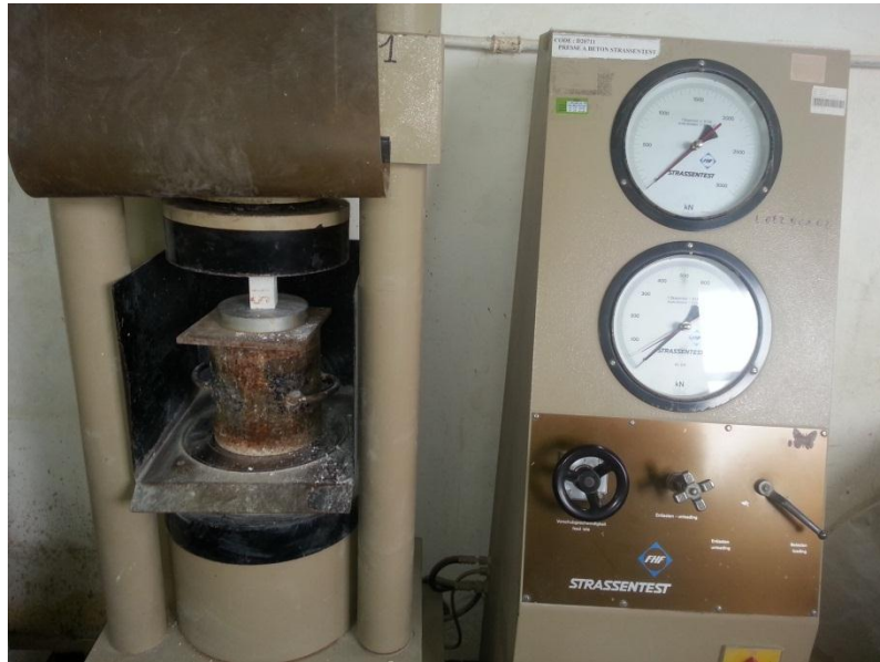
Figure18 : dispositif d'essai de la résistance à la compression
