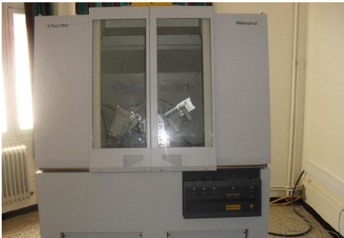
Figure II.4 : Diffractomètre utilisé pour la diffraction des rayons X.
