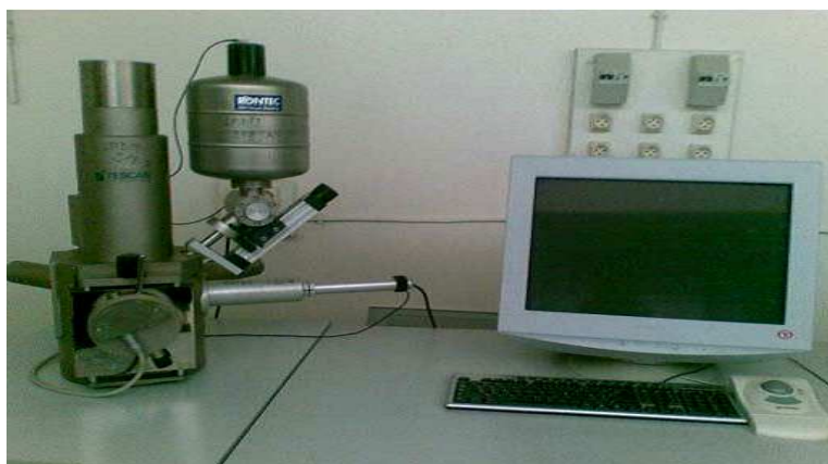
Figure III. 3 : Microscope électronique à balayage (MEB).
