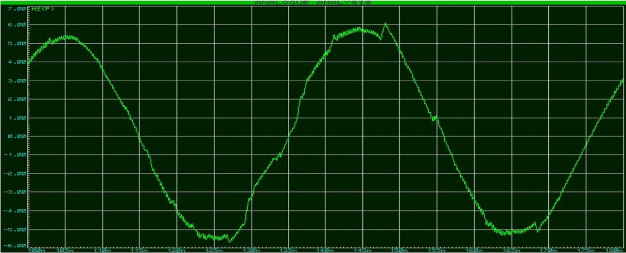
Figure IV.21 Courant de la phase de sortie  $i_a$ .
