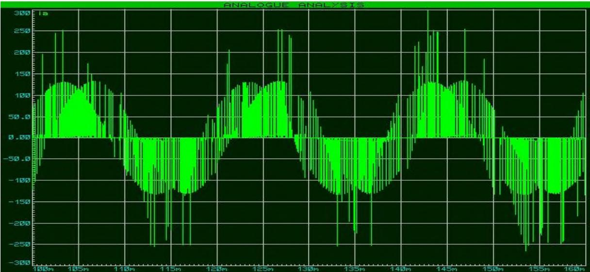
Figure IV.19 Courant de la phase d'entrée  $i_A$ .
