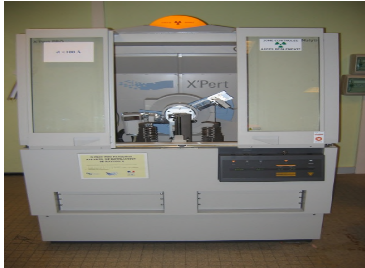
Figure (5) : L'appareil de la DRX
