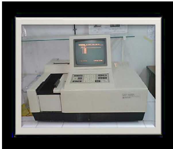
Figure(6) : Spectrophotomètre UV-visible
