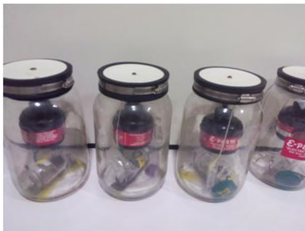
Figure 32. Système passif pour la mesure du gaz ^{222}\text{Rn} dans l'eau
