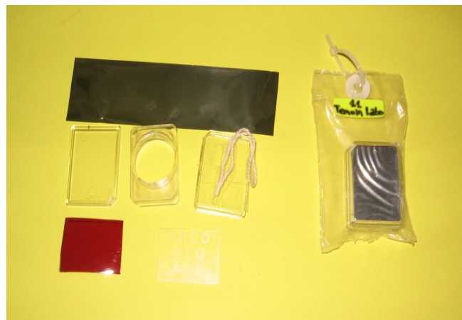
Figure 24. Dosimètre de radon à base de détecteur solide de traces nucléaires
