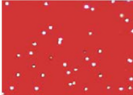
Figure 8. Traces de particule a révélées dans le LR-115
