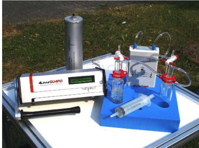
Figure 30. Système AquaKIT pour la mesure du gaz radon dans l'eau
