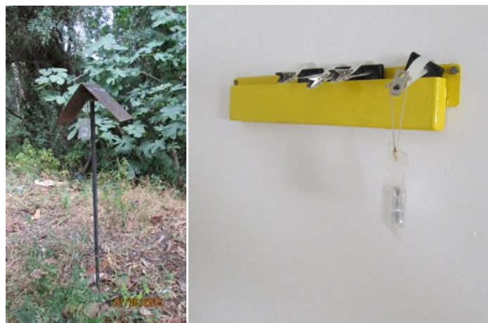
Figure 29. Emplacement des DSTN à l'air libre et au niveau du laboratoire
