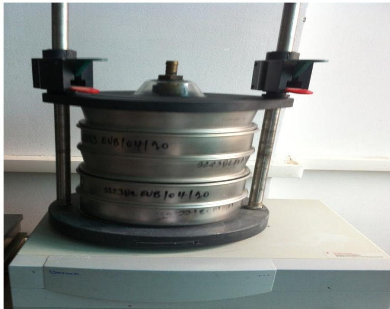
Figure 7 : photo montrant une série de tamis sur un vibro-tamis de type RETSCH.
