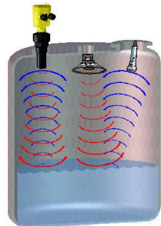
Figure II.5 : capteur de niveau
