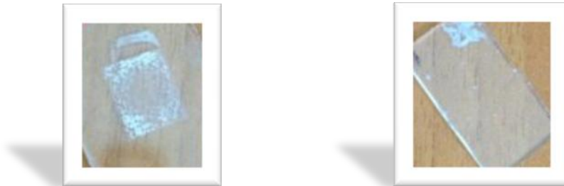
Figure IV .B.1.1.1.b : Détérioration des dépôts de dioxyde de titane de la 1 ère (à gauche) et 2 ème (à droite) familles.
