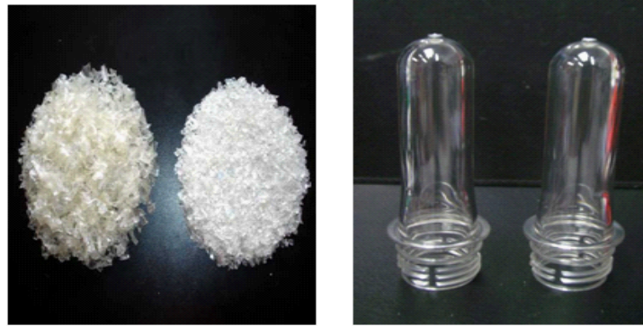
Figure 2 – 3 : Transformation du PET en préformes
