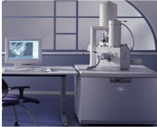
Figure.II.7: Photo d'un microscope électronique à balayage.
