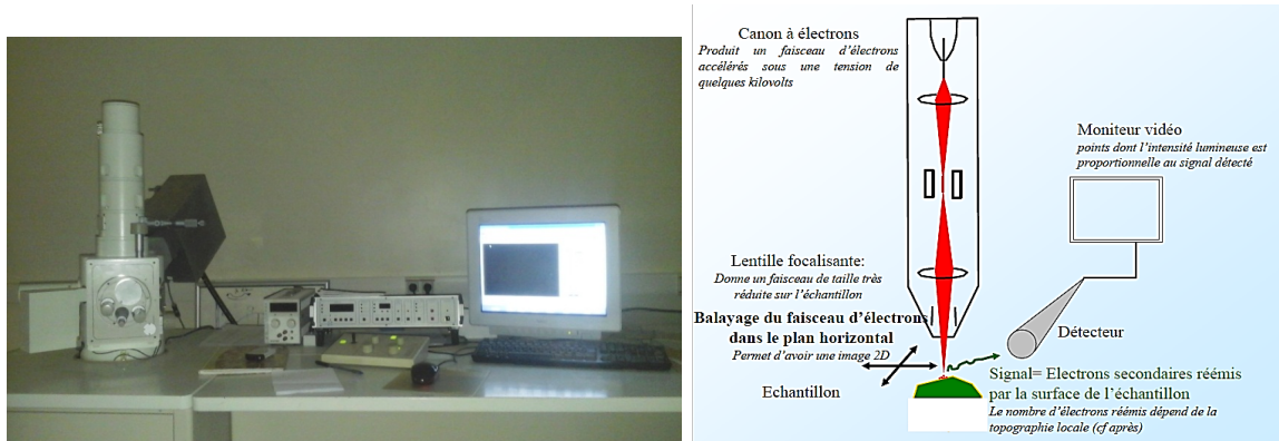
FIGURE 2.12 – a) Microscope électronique à balayage ; b) Principe du microscope électronique à balayage.
