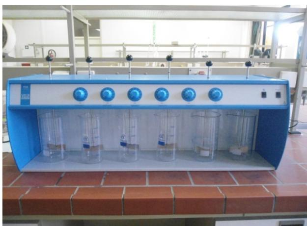
Figure II.3 : Photographie du jar test utilisé.
