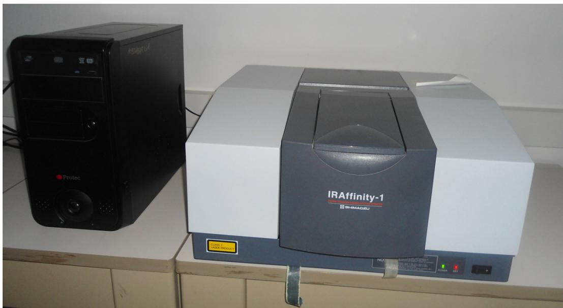
**Figure II.2 :** photographie de l'appareil utilisé pour identifier les groupements chimiques.
