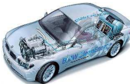
(b) Implantation d’un stockage cryogénique couplé à moteur à combustion interne
