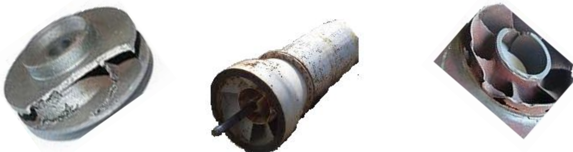
Dégâts de Cavitation sur les éléments d'une pompe centrifuge Figure (IV.25)
