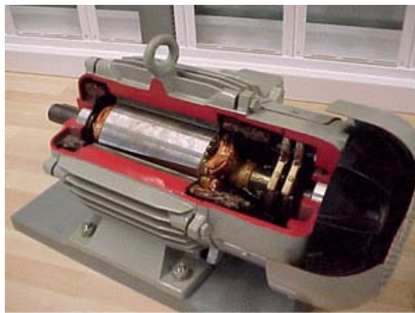
FIGURE 1.30 – Vue d'un rotor bobiné d'un moteur synchrone.
