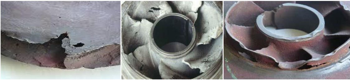
Figure (IV.11): Erosion par cavitation sur les aubes d'une pompe centrifuge
