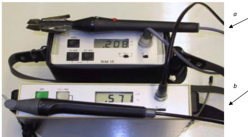
Fig. III. 2: Dispositif de surveillance de la sévérité de pollution SLM 10 (a: Sonde à électrodes planes, b: Sonde à électrodes linéaires)
