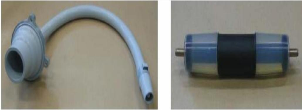
**Fig. 2. 10** a) Prototype de l'isolation d'une connexion moyenne tension souple en bout de câble; b) Prototype de l'isolation d'une connexion moyenne tension souple
