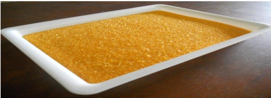
**Fig. 4. 6:** Gel de silice (silicagel)
