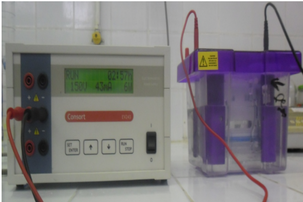
Figure 07 : Cuve et accessoires du dispositif d'électrophorèse (Thermo Scientific).
