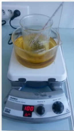
Figure 4: Photo de l'expérience de démucilagination enzymatique
