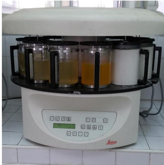
Figure 8: Automate de circulation (photographie originale).
