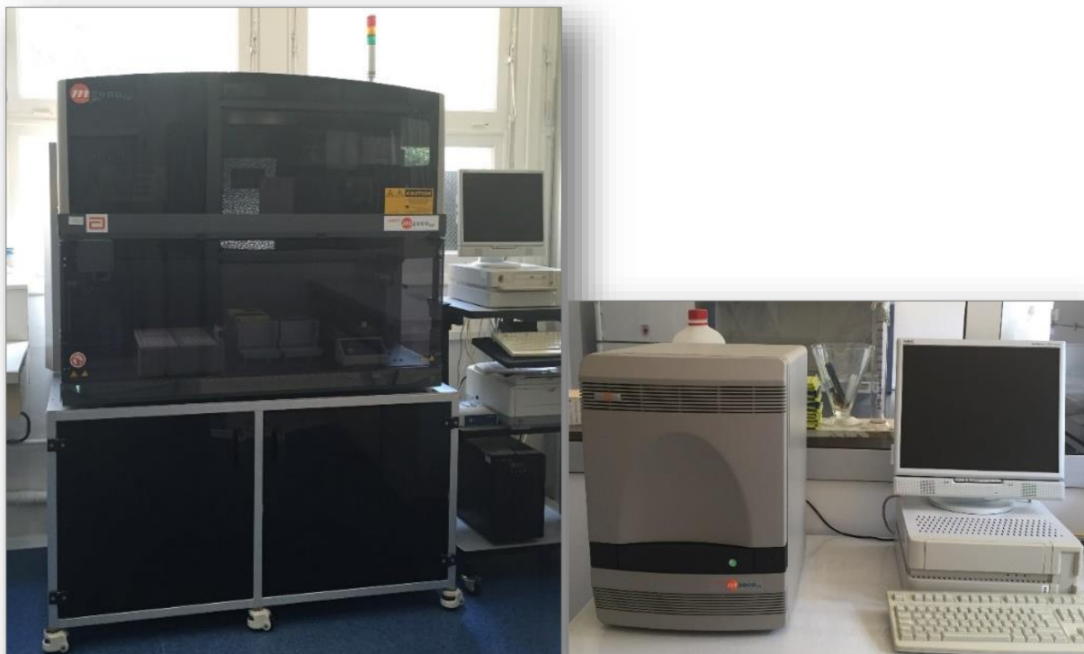
Figure 09 - Appareil Abbott Real Time HIV-1, composé de l'extracteur à gauche (m2000sp) et de l'analyseur (thymocycleur, m2000rt) à droite.
