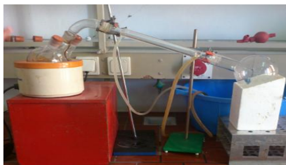
Figure 5: Photographie du dispositif d'hydrodistillation.
