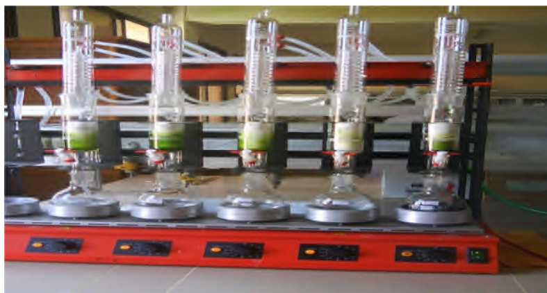
Figure N°06 : Photographie de l'extracteur multipostes « Soxhlet ».
