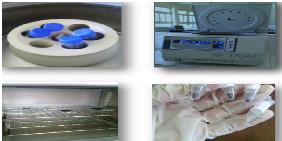
Figure II.5 : Différentes étapes de la préparation des poudres de Co, de la centrifugation à l'étuvage.
