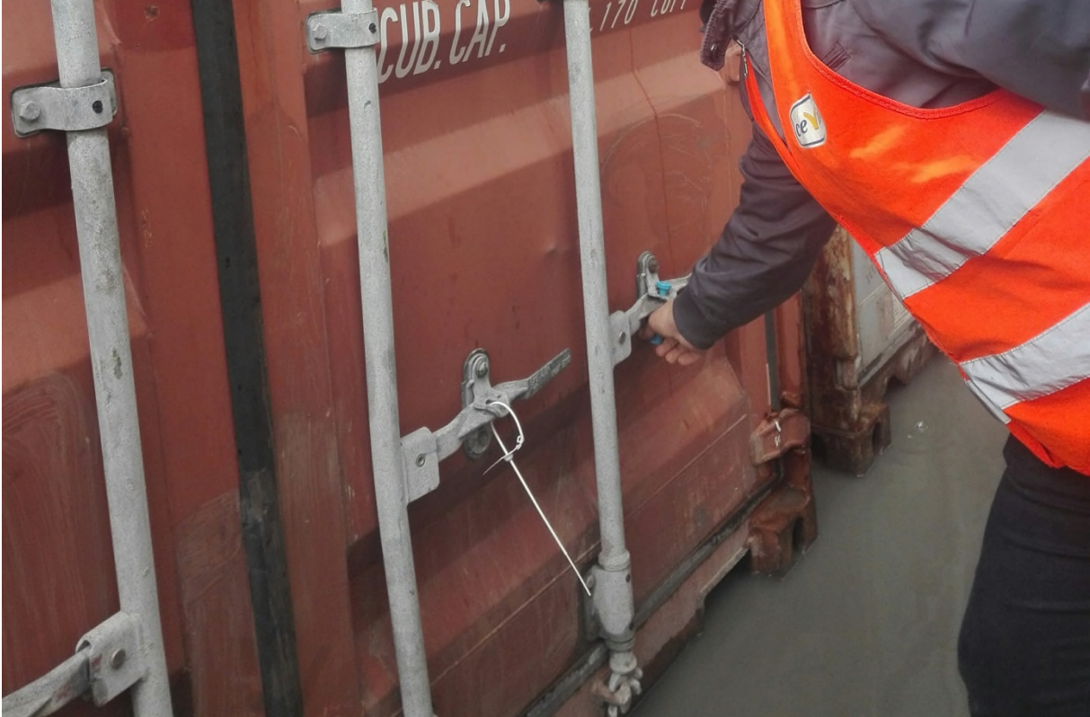
Figure N°27 : Scellement des conteneurs.
