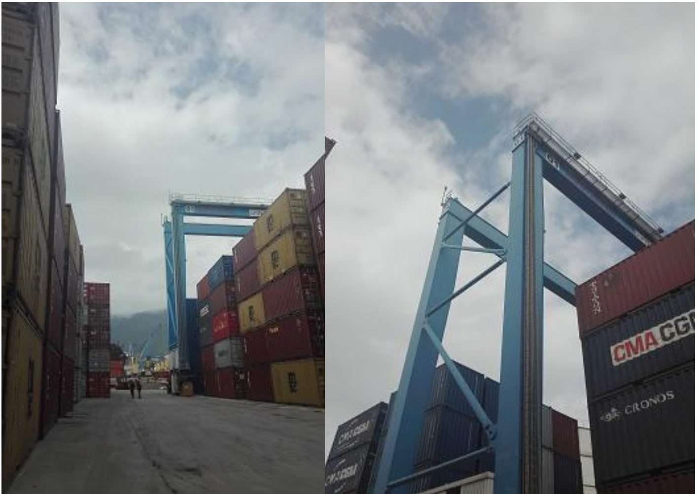
Figure N° 33 : Grues portiques sur pneus (RTG) de cevital .
