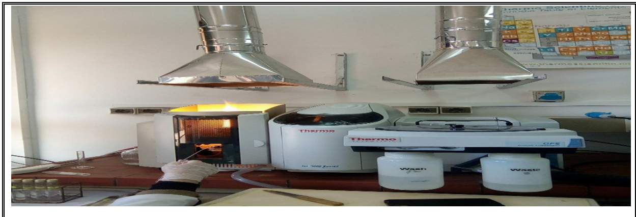
Figure N° 17:Le spectromètre d'absorption atomique en flamme (AA6501F/SHIMADZU - Laboratoire Génie des procédés, Université de Bejaia).
