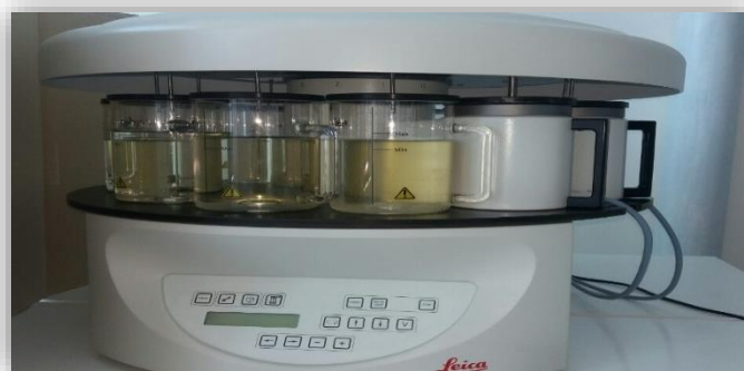
Figure 25: Photographie originale de l'automate de déshydrations
