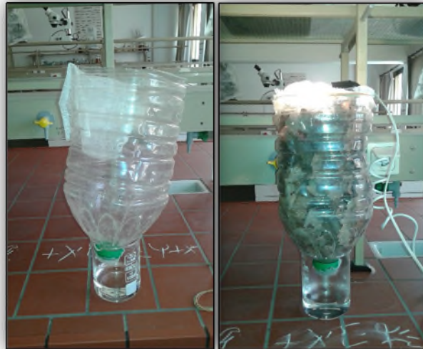
Fig.23- Appareil de Berlèse
