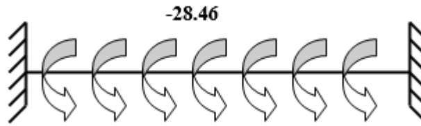
Figure. III. 24 Les moments de torsion sur la poutre palière.
