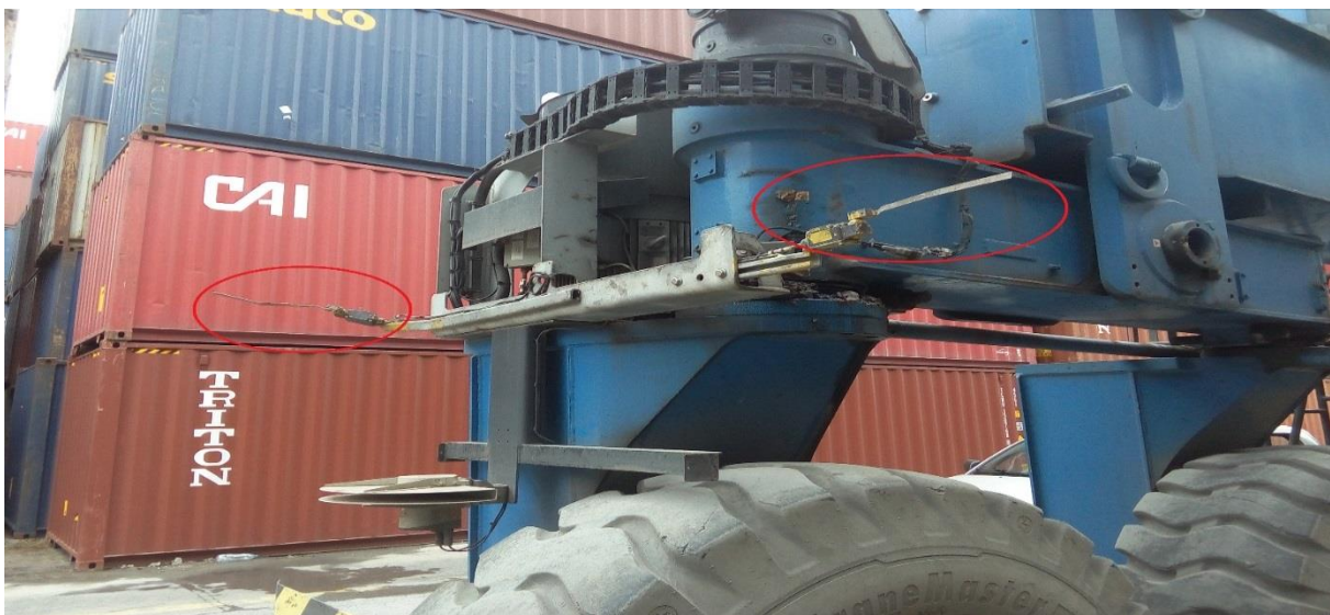
Figure (I.12) : Capteur fin de course anticollision
