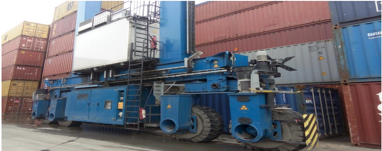
Figure (I.6) : Chaîne de translation de la RTG.
