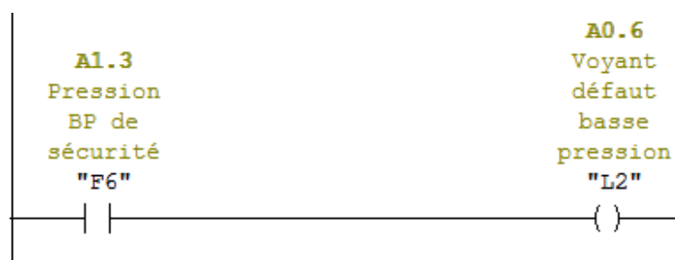
Figure III. 14: Schéma ladder de voyant défaut de basse pression « L2 »
