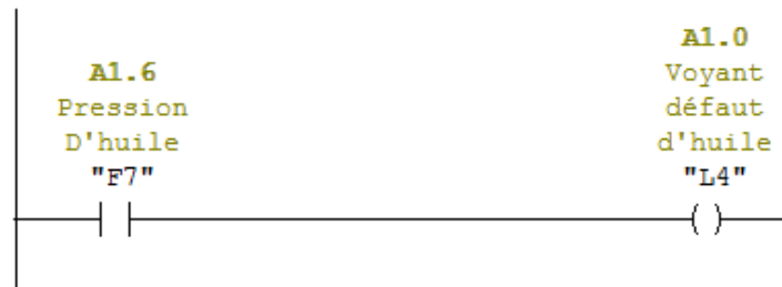
Figure III. 20: Schéma ladder de voyant défaut pression d'huile « L4 »
