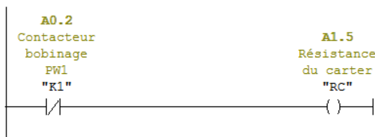
Figure III. 23: Schéma ladder de résistance du carter « RC »
