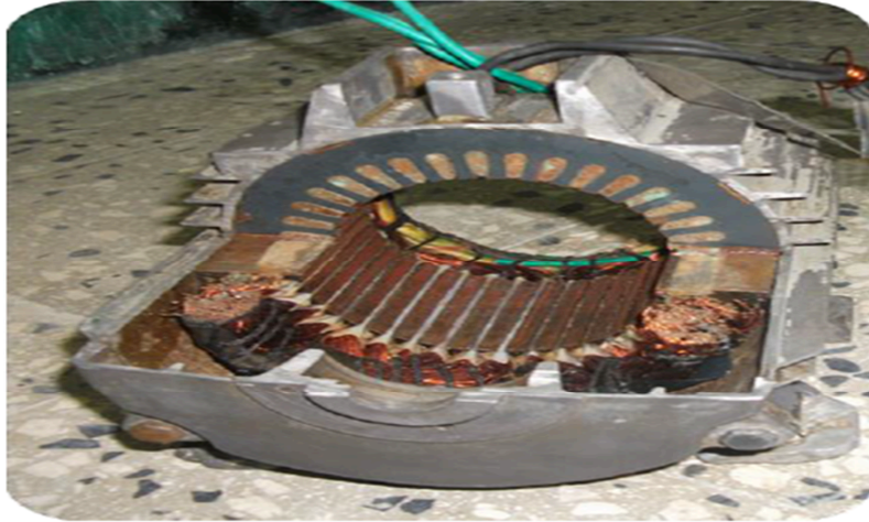
Figure III.2 : la coupe d'un stator de la MAS.
