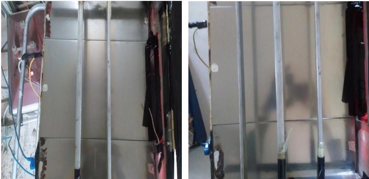
**Figure IV.20.b** : Photos montrent l'influence de nombre de lames sur la filtration des particules pour une vitesse plus fortes (40%)
