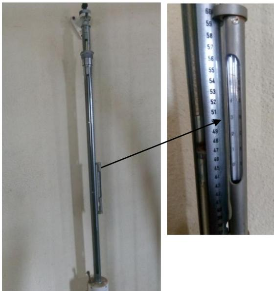
**Figure III.10 :** Un baromètre à mercure
