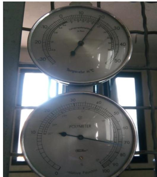
**Figure III.11 :** Un hygromètre à cheveux
