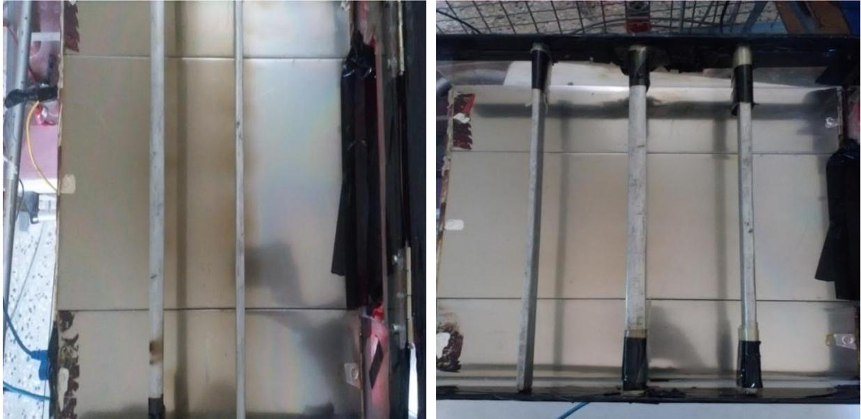
Figure IV.19.b : Photos montrent l'influence de nombre de lames sur la filtration des particules pour une vitesse moyenne (30%)
