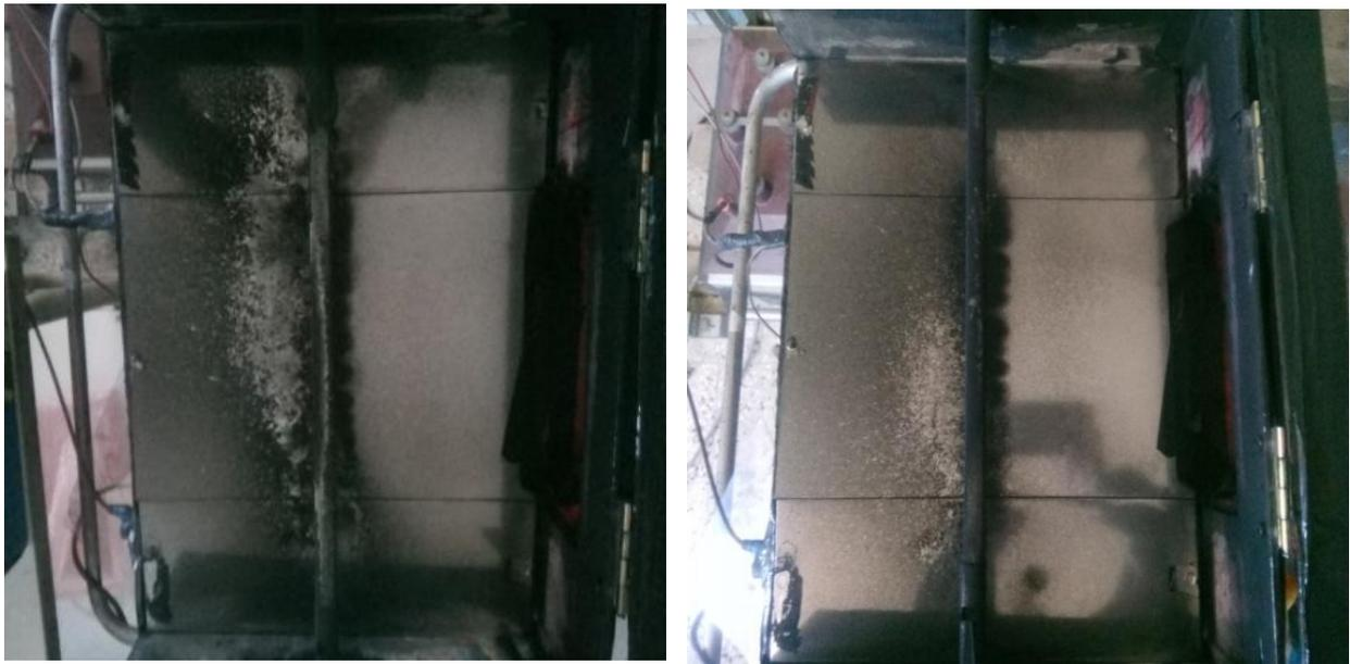
Figure IV.24.b : Photos montrent l'effet de la vitesse des particules sur l'efficacité de filtration
