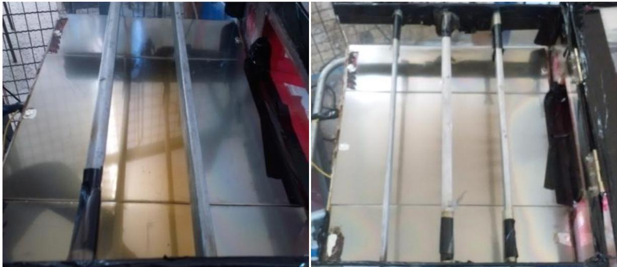
Figure IV.18.b : Photos montrent l'influence de nombre de lames sur la filtration des particules pour vitesse faible (20%)
