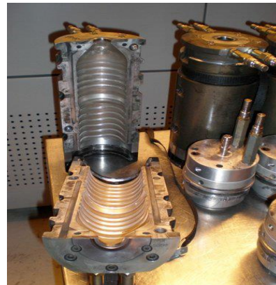
Figure (I.6) : moule ouvert dans lequel les préformes sont soufflées
