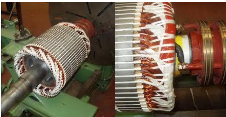
Figure (II.5) : Construction d'un rotor bobiné [6]
