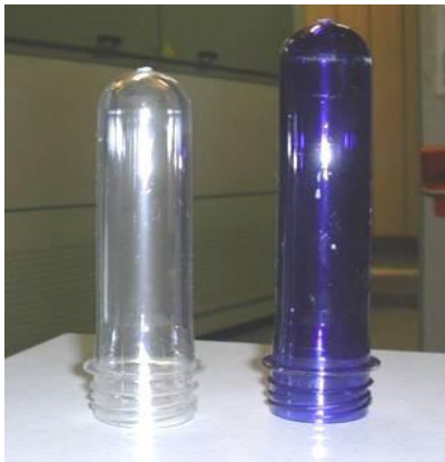
Figure (I.5) : préforme en PET
