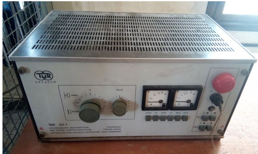
Figure II.3 : Photo de la source basse tension SG1
