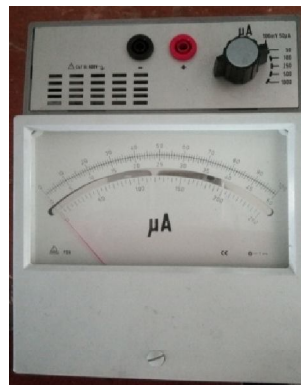
Figure II.11 : Microampèremètre à aiguille utilisé dans la mesure du courant de décharge
