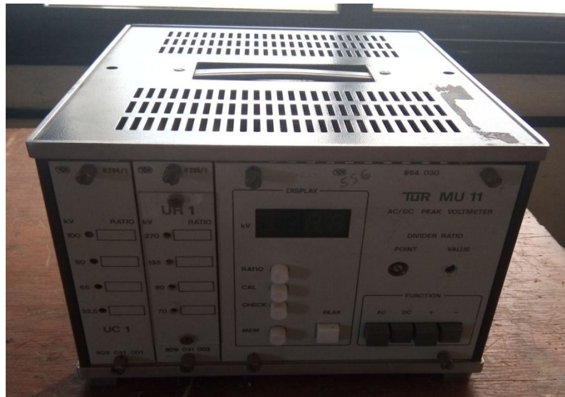
Figure II.9 : Voltmètre de crête
