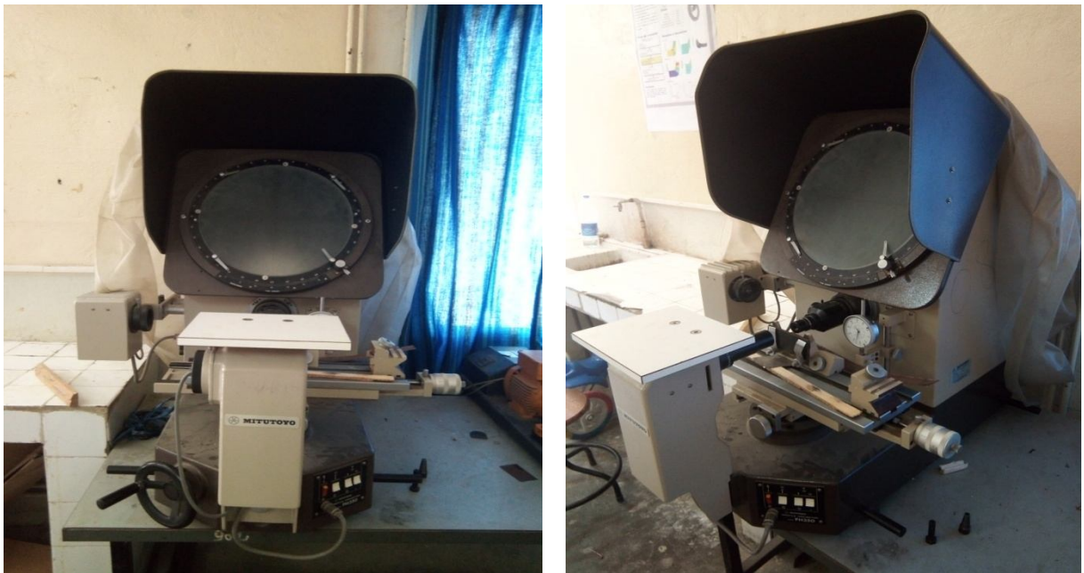
Figure II.8 : Photo de la machine projecteur de profil
