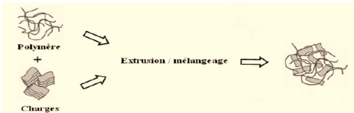
**Figure II.4:** Principe d'élaboration de nanocomposites par voie fondu [17].
