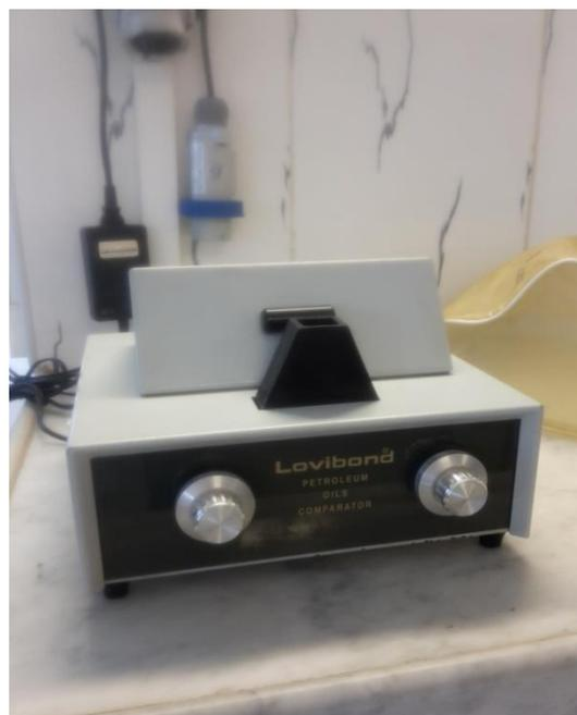
Figure III.11. L'appareil de Colorimètre Lovibond.
