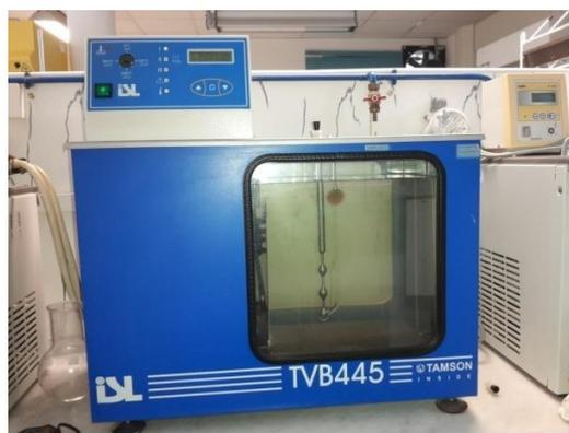
**Figure III.8.** Bain viscosimétrique rempli de l'huile de silicone modèle **ISL TVB445**
