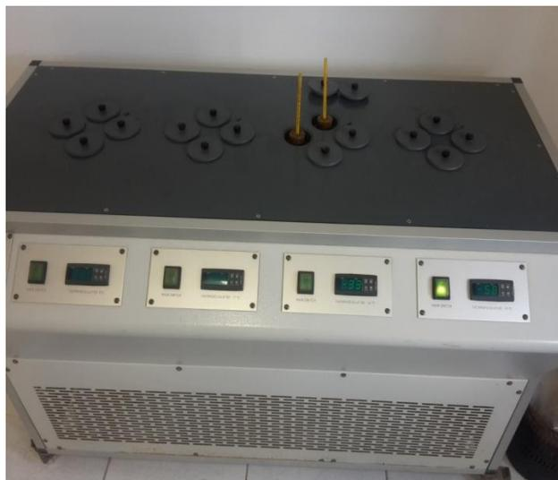
**Figure III.5.**Appareil de mesure du point d'écoulement.
