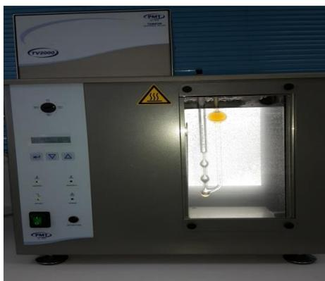
**Figure III.7.** Bain viscosimétrique rempli d'eau distillé **PMT TV2000**
