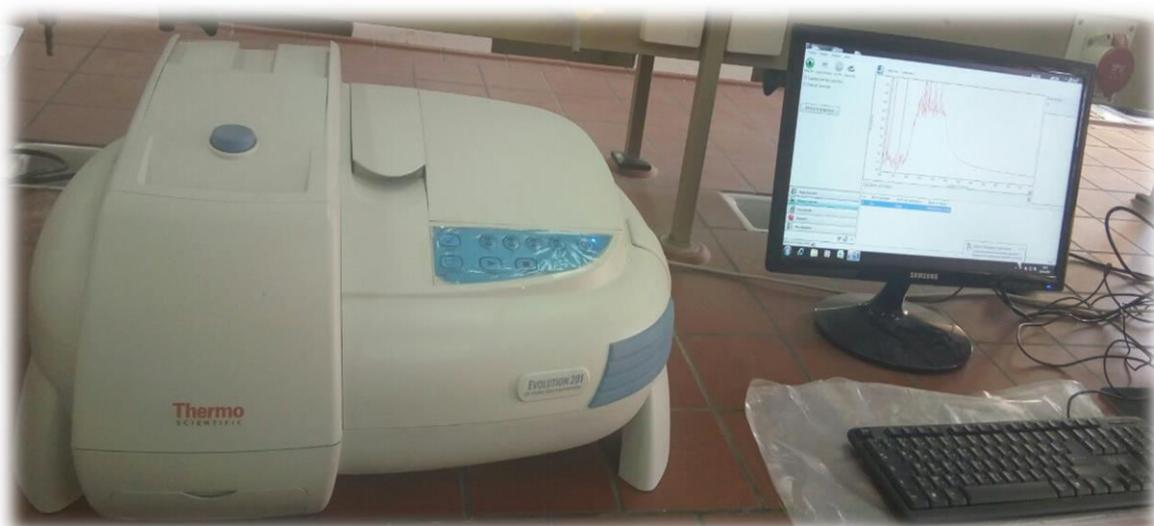
**Figure. II.7. Spectromètre UV- visible**
