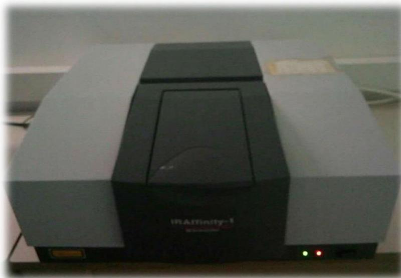
**Figure. II.6. Spectromètre infrarouge à transformée de Fourier**
