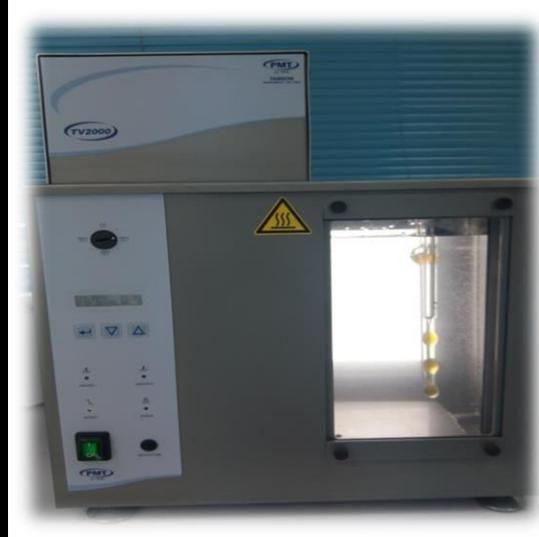
Figure. II.3. Bain viscosimétrique à 40°C
