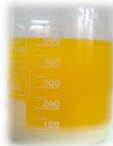
**05)** Laisser au repos jusqu'à dépôt total de la phase lourde (eau et matière sèche)
