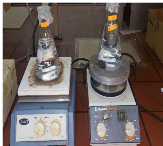
Figure II.6. Photographie des échantillons immergés dans l'eau distillée durant le test d'absorption.
