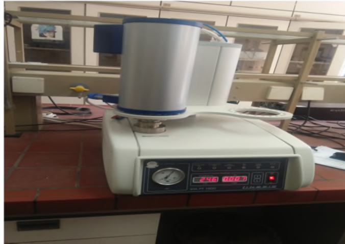
Figure II.7 : Appareil d'analyse thermogravimétrique.
