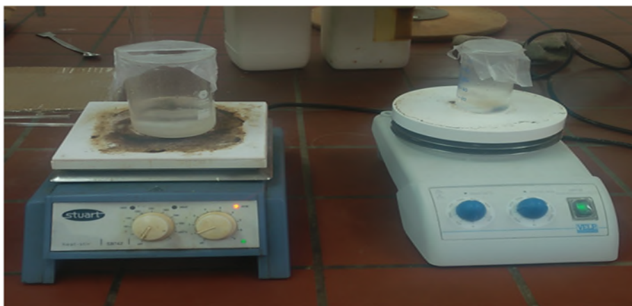
Figure II.8 : Photographie des échantillons immergés dans l'eau distillée durant le teste d'absorption.
