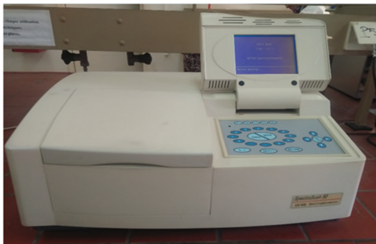
Figure II.4 : Appareille de spectrophotométrie UV-visible
