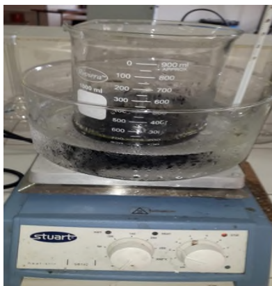
Figure III-2 : Montage utilisé pour la synthèse de l'oxyde graphène
