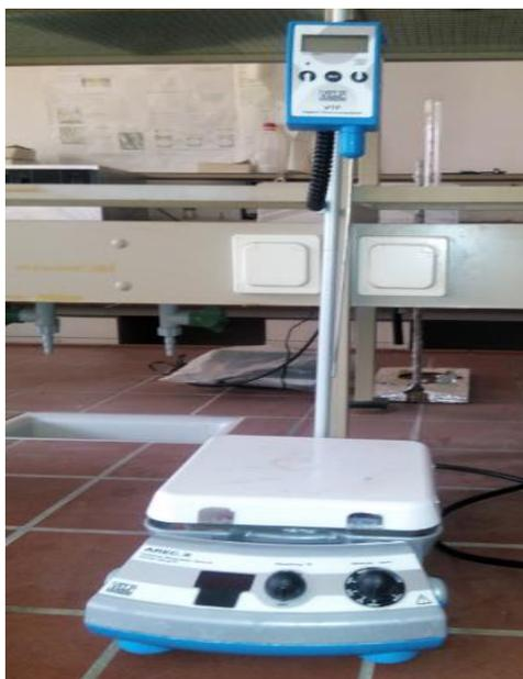
**Figure 1.4** : photo de la plaque chauffante avec agitateur magnétique.
