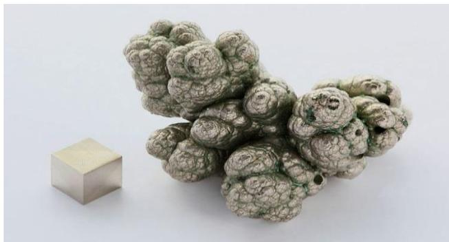
**Figure I. 5 :** Photo montrant un nodule de Nickel pur (99,9%), raffiné par électrolyse, à côté d'un cube d'1 cm (Wikipédia,2016).
