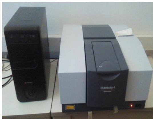
**Figure 1.7:** Photos du spectrophotomètre SHIMADZU IRAffinity-1 à transformée de Fourier
