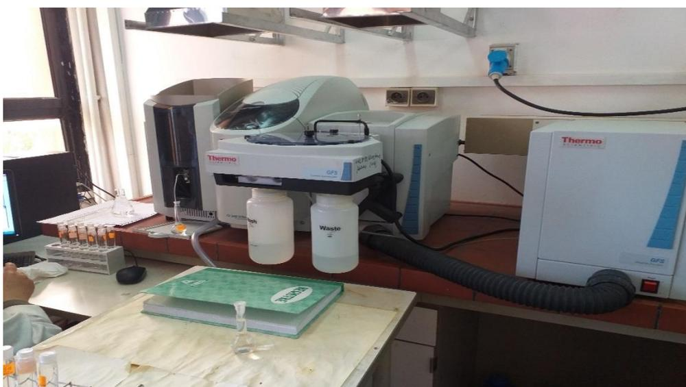
**Figure1.6 :** spectrophotomètre d'adsorption atomique
