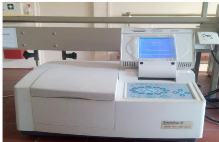
**Figure 1.3:** Photo montrant spectrophotomètre UV-Visible utilisé.
