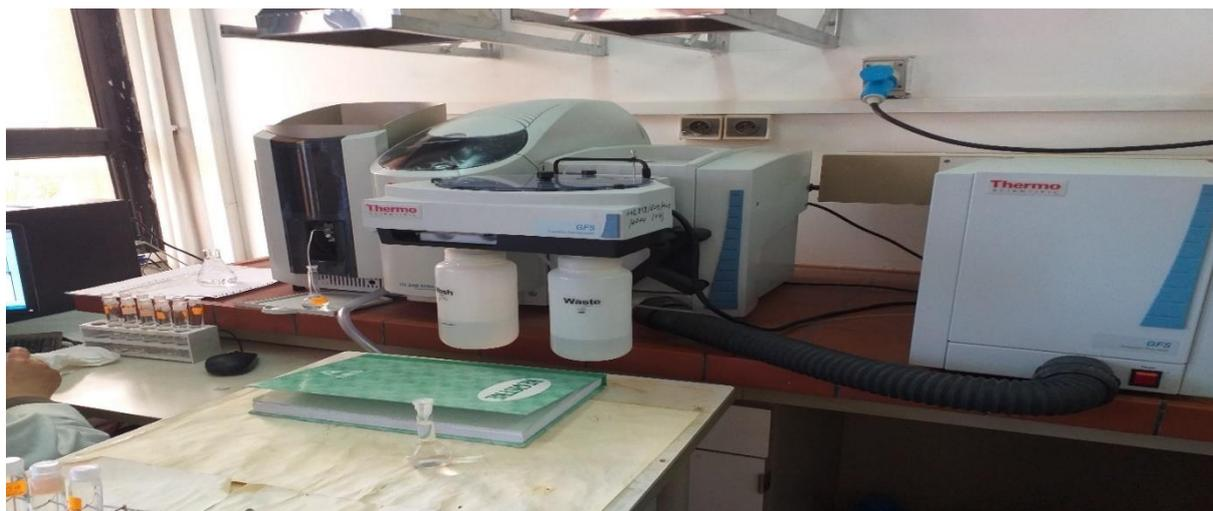
**Figure II.3 :** Appareillage de spectrophotométrie d'adsorption atomique.
